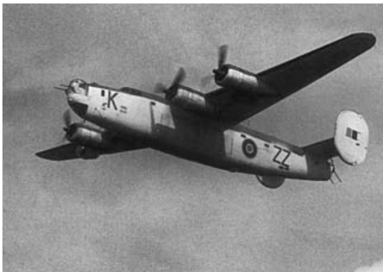
Liberator GR Mk IV de la Escuadrilla 220 con base en las islas Azores. Para operaciones nocturnas debajo del ala de estribor lleva el proyector Leigh de cinco millones de bujías.
