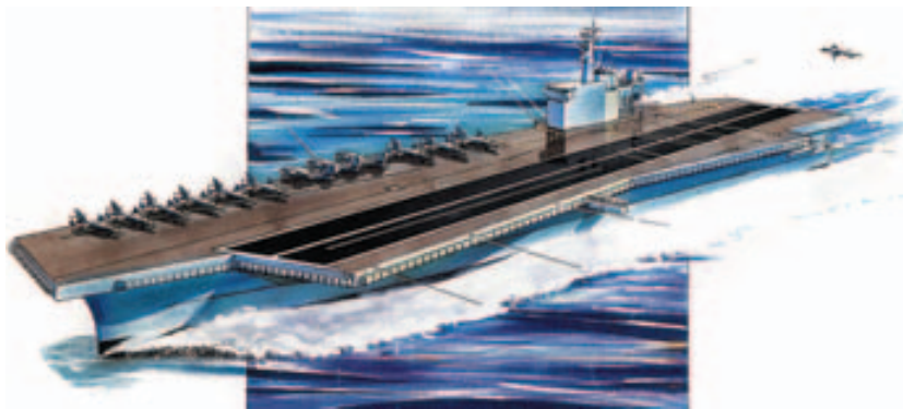
Visión artística del proyecto de portaaviones ofrecido a la Armada Argentina a mediados de la década de 1990. Capaz de operar con aviones F-18 Hornet. Costo de construcción poco más de 350 millones de dólares.
